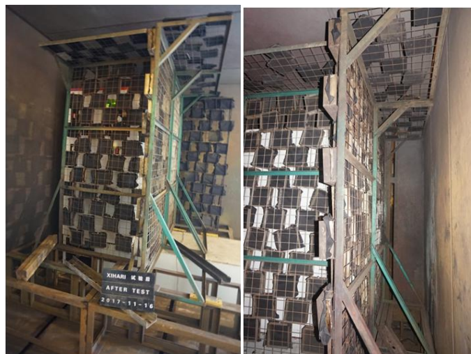
图 2 内部电弧试验的试验布置
